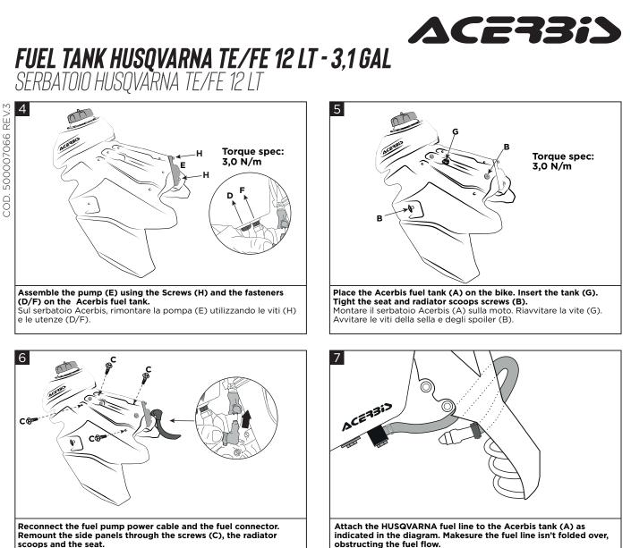
Riconnettere il cavo di alimentazione pompa e il connettore benzina. Rimontare i fianchetti tramite viti (C), gli spoiler e la sella. ATTENZIONE: dettaglio montaggio tubo/pompa. Fissare il tubo pompa come indicato. Fare attenzione che il tubo piegandosi non crei strozzature.
